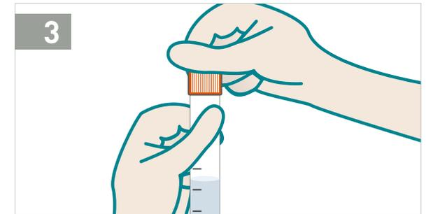
3. Verschließen Sie das Probenröhrchen samt Probe mit der Kappe.
